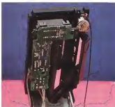
Un particolare dell'hub di ingresso della scanner-Chinon. Sono visibili le zone di speck che invadono l'immagine al sensore CCD ed il microprocessore che aziona lo speckfree: motore per l'espulsione del documento scansionato.
